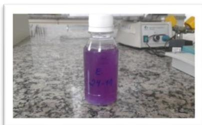
**Fig. 3** Frasco com solução em púrpura indicando ausência de contaminação com coliformes totais seguindo técnica do substrato cromogênico.
