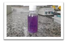
**Fig. 3** Frasco com solução em púrpura indicando ausência de contaminação com coliformes totais seguindo técnica do substrato cromogênico.
