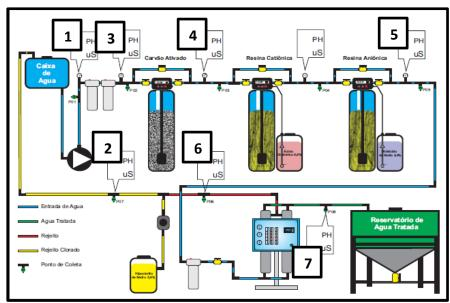
**Fig. 1** Ilustração dos componentes do sistema de tratamento de água destinada a hemodiálise com os respectivos pontos de coleta destacados em negrito (*detalhes no texto*).
