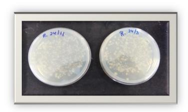
**Fig. 2**Placas de petri com colônias de bactérias heterotróficas provenientes da inoculação de amostras de água coletadas no ponto de coleta reuso (R) em meio Àgar-nutriente.
